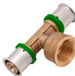
T-Stück mit Abgang Innengewinde - 32 x 3/4"IG x 32
