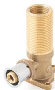
Wandscheibe mit 3 Befestigungslaschen Gewindeschenkel 30 mm länger - 16 x 1/2"IG
